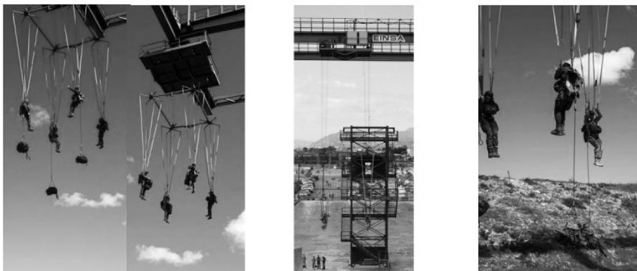
**Рис. 11. Приспособления для тренировки деятельности парашютиста при начальной подготовке от момента отделения от ЛА до приземления (Испания)**
